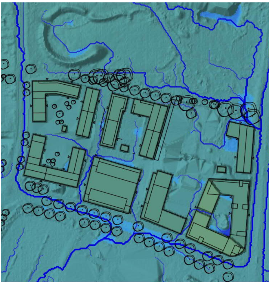
Figur 7: Rinnvägar och lågpunkter efter exploatering utan höjdsättning.
